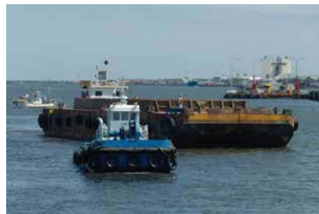
グラブ浚渫船に横付けされた土運船が、土砂で満杯になろうとしている頃、岸壁に待機していた、もう1隻の土運船が揚錨船によって移動を始める。
